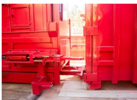
**DISPOSITIF HYDRAULIQUE D'ACCROCHAGE ET D'ÉJECTION DE CAISSES** Tracte et accouple les caisses à compaction éloignées du compacteur hydrauliquement
