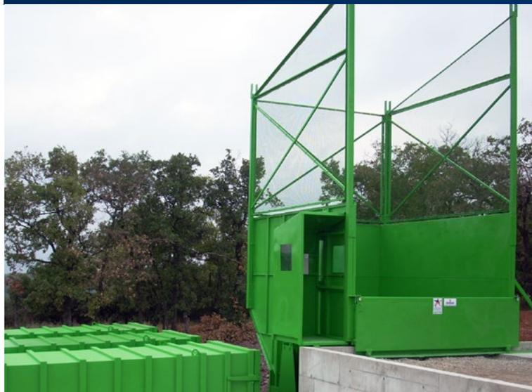
La trémie de déchargement est adaptée à chaque cahier des charges préétabli et permet de charger des quantités de déchets importantes. La forme tubulaire avec des parois verticales (et non évasées) évite le risque de formation de voûtes. Ainsi, les déchets ne peuvent pas s'accrocher sur les flancs de la trémie lors de leur chute dans la chambre de presse.
