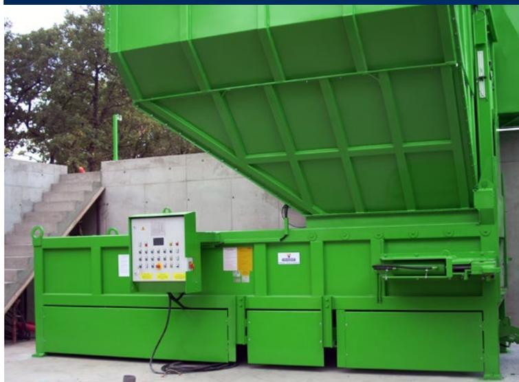
Une force de compaction optimale assure une compaction élevée des matériaux. La pénétration importante du bouclier de compaction dans la caisse garantit à la fois un poids élevé de caissons et une bonne fermeture de l'orifice de remplissage. Des débits élevés de déchets sont garantis grâce à des temps de cycle adaptés à la puissance du compacteur et aux types de déchets compactés.
