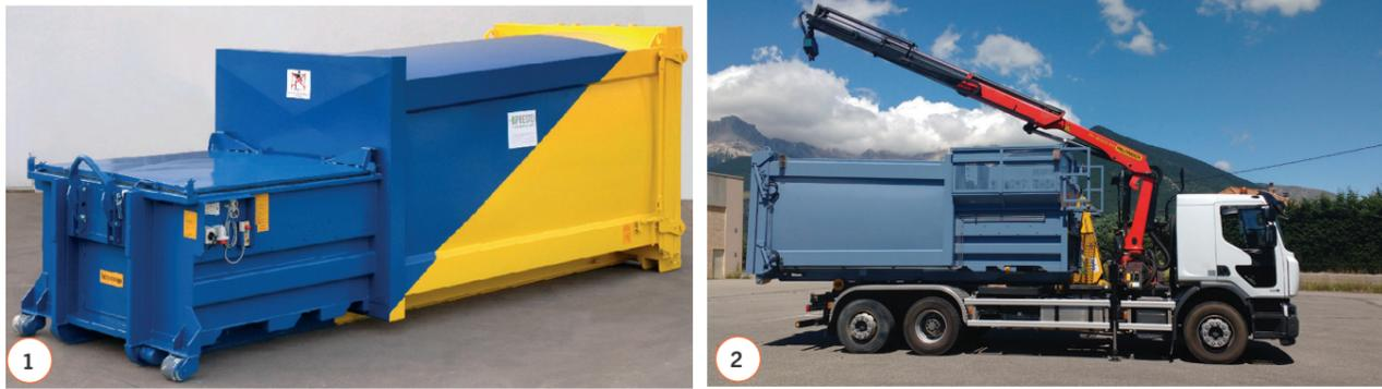
Equipés d'un compacteur monobloc embarqué et d'un ensemble polybenne-grue, les véhicules sont particulièrement adaptés pour répondre à l'activité collecte sélective.
