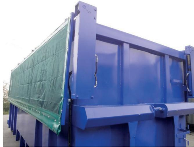
Caisson cadre filet hydraulique fermé
